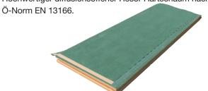
$\begin{array}{lll} \mbox{Wärmeleitfähigkeit} \ \lambda_D: & 0,022 \ \mbox{W/mK}^* \\ \mbox{Plattenabmessungen:} & 2500 \ \mbox{x} \ 1000 \ \mbox{mm} \\ \mbox{Nutzmaß:} & 2480 \ \mbox{x} \ 980 \ \mbox{mm} \\ \mbox{Lieferdicken:} & 100-300 \ \mbox{mm} \\ \mbox{Kantenausbildung:} & \mbox{Nut und Feder} \end{array}$
