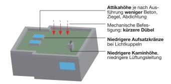
Falls das Flachdach gedübelt wird, ergibt sich eine zusätzliche Kostenersparnis, da durch die geringere Dicke nun auch nur mehr kürzere Dübel benötigt werden.
