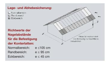
Der Dachschub (aus Eigengewicht, Schneelast, Dachdeckung etc.) wird über das Traufenholz oder über die Knaggen aufgenommen. Windsogkräfte werden durch eine gleichmäßige Nagelung oder Verschraubung über die Konterlatten abgetragen. Da naturgemäß im Randbereich und im Eckbereich von Dächern höhere Windkräfte auftreten, ist dort eine dichtere Nagelung bzw. Verschraubung auszuführen. Hier ist notwendig schon nach der 2. oder 3. Dämmstoffreihe die Konterlattung zu verlegen.
