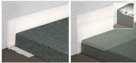
Trennlage zwischen Mauerwerk und Estrich zur Vermeidung von Schallübertragungen
