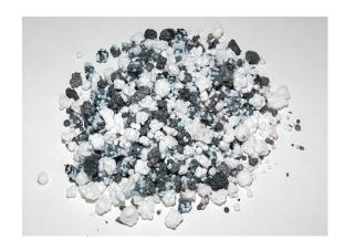
Anwendung: Hohlraumdämmung, Zuschlagsstoff, zur Bodenverbesserung, etc.
