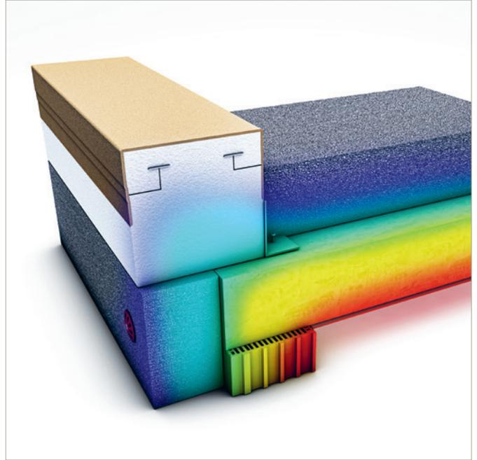
Im Vergleich zur herkömmlichen Attika können keine Wärmebrücken entstehen. Die Temperatur verläuft kontinuierlich über die gesamte gedämmte Außenhülle des Bauwerkes. Damit wird erfolgreich einer möglichen Schimmelbildung entgegengewirkt.
