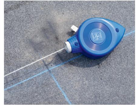
3. Die Markierung wird mittels Farbschnur am Untergrund angezeichnet.
