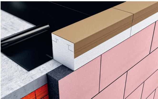
Erfolgt die Verklebung auf einer vorhandenen Dampfsperre, muss die Haftung am Untergrund gewährleistet sein. Bei Montage der Austrotherm Attikaelemente wie im Bild ersichtlich, darf die verklebte Auflagefläche (mind. 50 %) nicht kleiner als die Auskrantung sein (Gesamtdicke WDVS).
