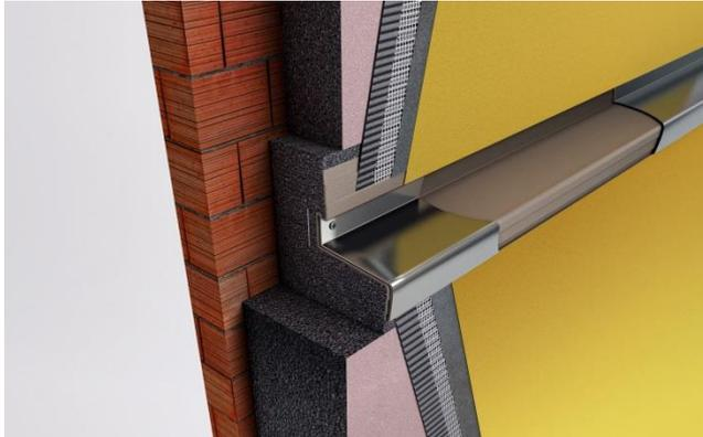
Vorgefertigtes Gestaltungselement für Fassaden mit Befestigungsmöglichkeiten für Verblechungen.
